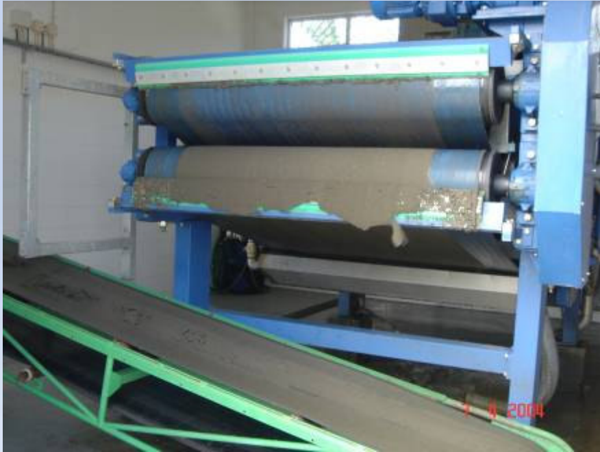
Desidratação Mecânica de lamas Filtro Banda
