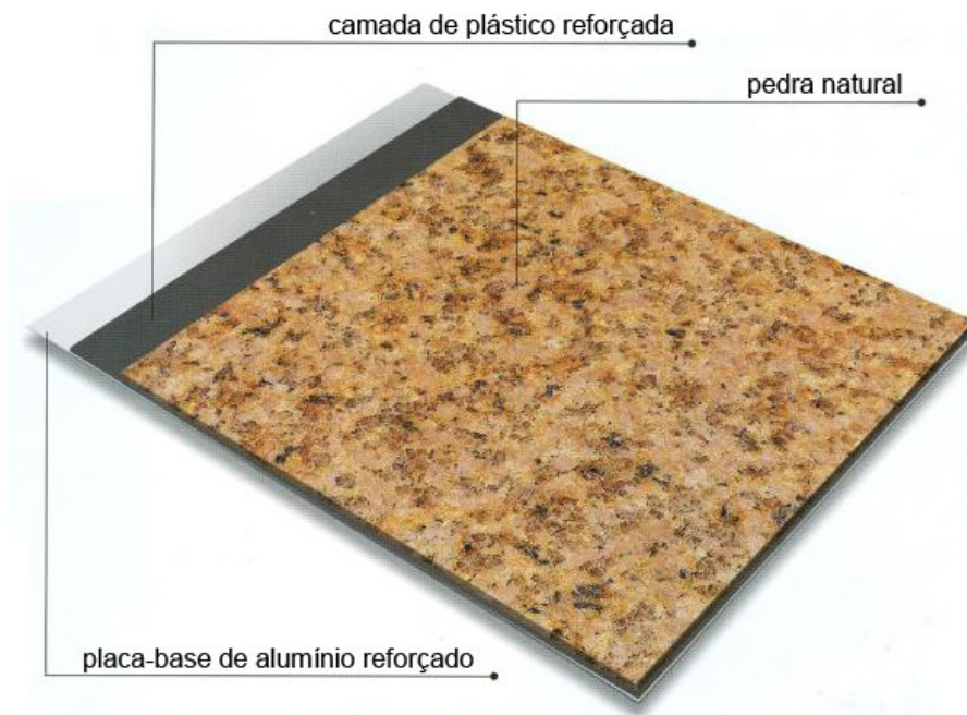
Fig.4 Painel reforçado com alumínio composto
